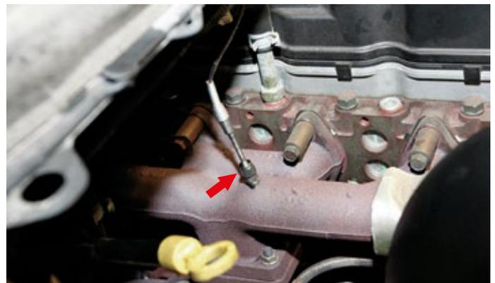
Für eine optimale Einspritzmengenberechnung wertet das Stage 3 TD den Ladedruck sowie Abgastemperatur aus. Der EGT/AGT-Geber gehört selbstverständlich zum Lieferumfang Ihres Stage 3 TD-Systems.
