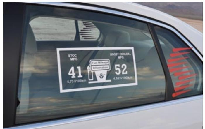
VW Jetta 2.0 TDI mit Boost Cooler Stage 3 MPG-MAX. Ohne Boost Cooler 5,73l/100km mit aktiviertem Boost Cooler sank der Durchschnittsverbrauch auf 4,52l/100km. Die Leistungssteigerung betrug 35PS. Testbericht nachzulesen im Diesel World Magazin Vol.6/Nr.5.
