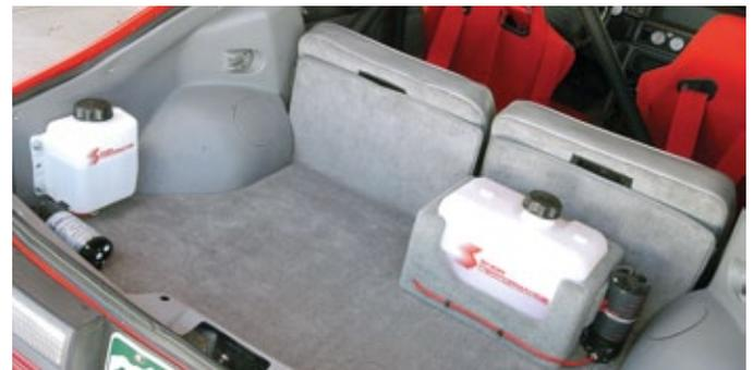
Einbaubeispiel 3l Tank (für separate Bremsenkühlung) und 9.5l Heckeinbauset mit Pumpe
