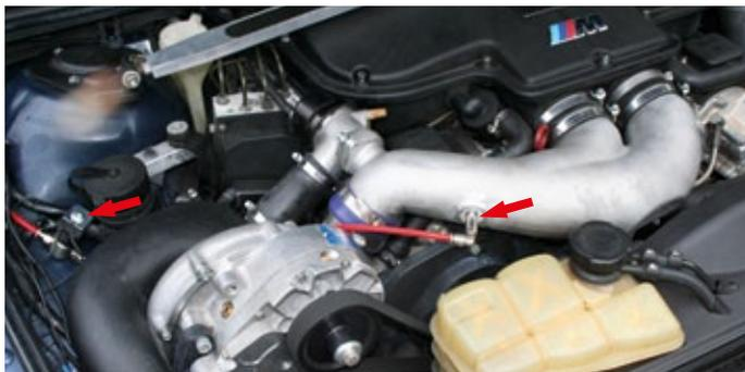
BMW M5 Kompressor mit Boost Cooler Stage 2 und verbaubtem Magnetventil (links)
