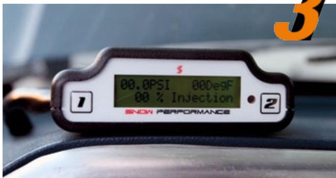
Das Cockpit-Display zeigt den Ladedruck (PSI oder BAR), Abgastemperatur (umschaltbar °C/°F) und die aktuelle Boost Cooler-Einspritzmenge (in %) an. Es stehen zudem mehrere Anzeigemodi zur Verfügung.
