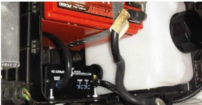
Einbaubeispiel: 3l Tank und Boost Cooler VC-100uC Steuergerät
