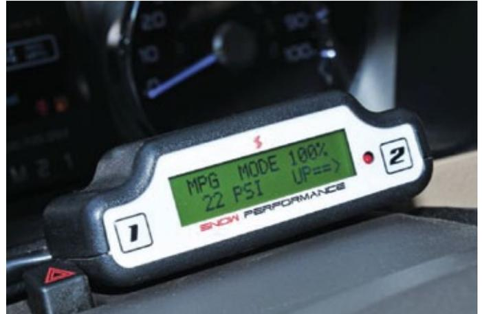
Wie auch beim Stage 3 TD, werden die benötigten Einstellungen einfach mit 2 Drucktasten am Steuergerät vorgenommen. Das MPG-MAX-Cockpit-Display zeigt ebenso den Ladedruck (PSI oder BAR), Abgastemperatur (umschaltbar °C/°F) und die aktuelle Boost Cooler-Einspritzmenge (in %) an.
