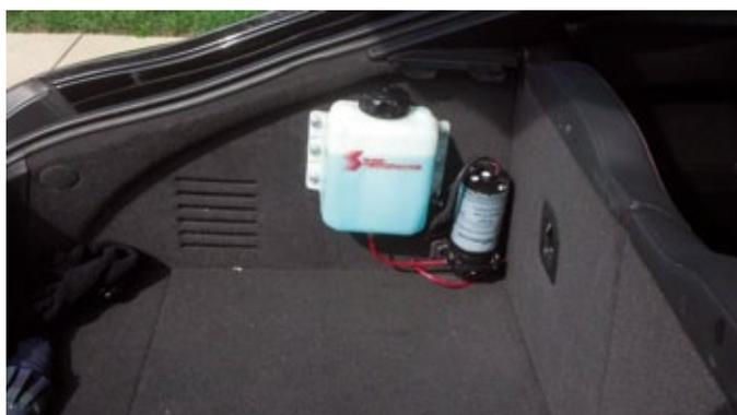
Einbaubeispiel: Audi TTS - 3l Boost Cooler Tank mit Pumpe im Kofferraum
