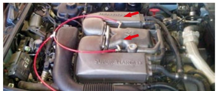
Jaguar XJR V8 Kompressor mit Boost Cooler Stage 2-MAF und Dual Düsen Upgrade
