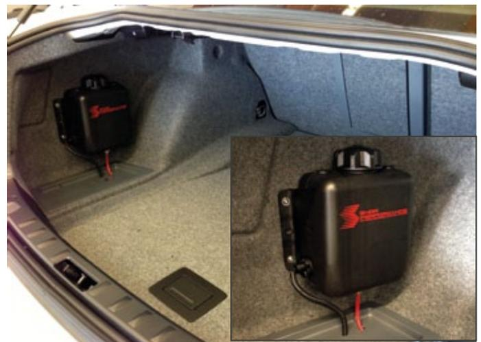
Einbaubeispiel BMW E92 - 3l Tank inkl. Pumpe im Kofferraum (nicht sichtbar unter dem Tank).
