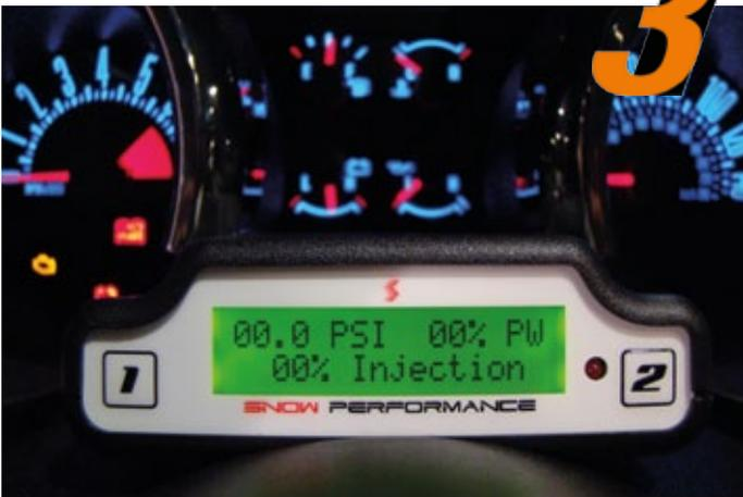
Das Cockpit-Display zeigt den aktuellen Ladedruck, (PSI oder BAR), Kraftstoff-Einspritzventiltaktung und zudem die aktuelle Boost Cooler-Einspritzmenge an.
