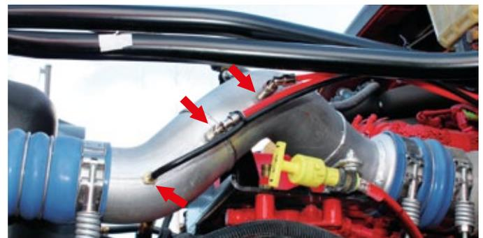
Einbaubeispiel 8.3l Cummins Diesel. Ladedruckentnahme (links) und 2 installierte Düsen
